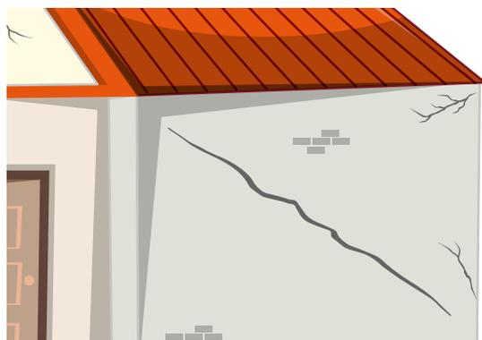
Si se detectan grietas con estas características, se recomienda usar testigos de yeso para monitorear su evolución. Estos testigos, se colocan sobre la grieta, y al agrietarse o romperse indican el crecimiento o movimiento de la misma.
